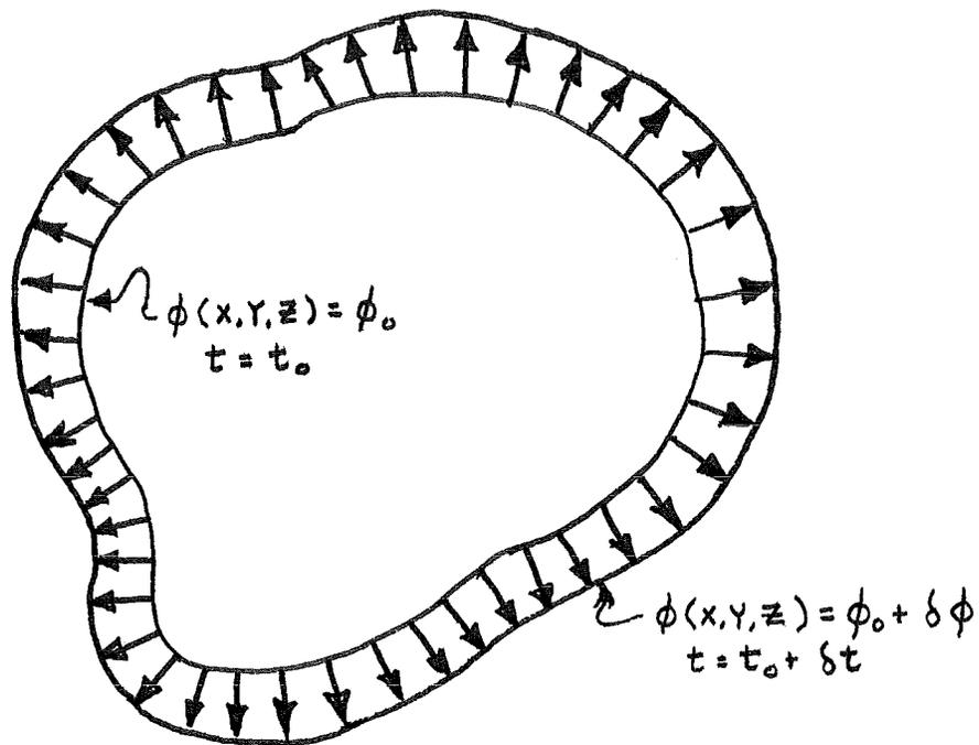
Fig. 2 : Equiphase surfaces or wave fronts,
